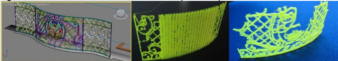
Figura 3. Modelo digital da grade central curva; impressão com o recurso de material de suporte; impressão sem este recurso.
