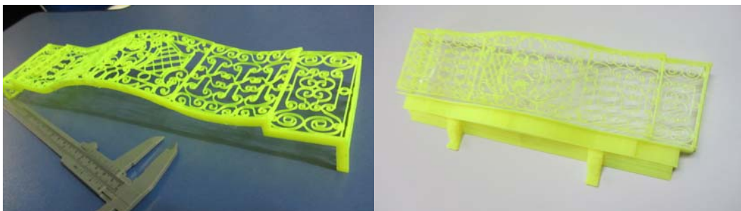
Figura 5. Grade fabricada por impressão 3D; maquete da sacada resultante.
