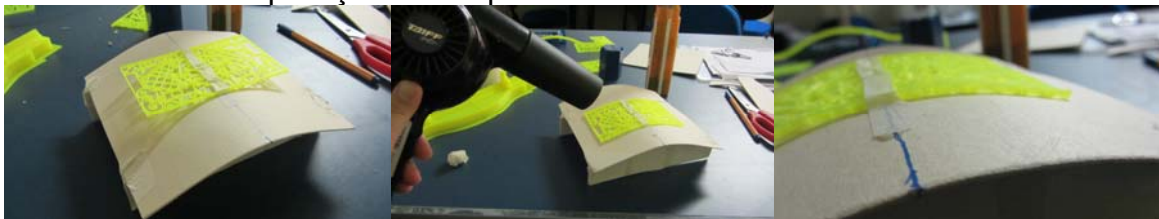
Figura 4. Grades inicialmente planas, fabricadas por impressão 3D; ao centro, aplicação de ar quente a fim de curvar as referidas peças; por fim, a peça moldada.
