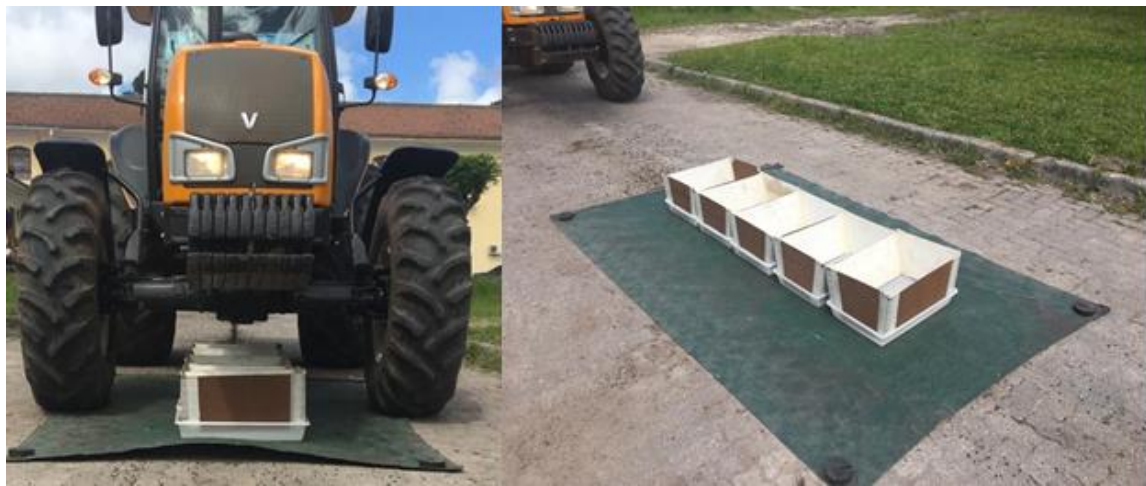
Figura 1 – Teste para medir a taxa de aplicação e a uniformidade de distribuição dos fertilizantes.
