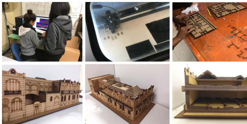
Figura 2: Na sequência: representação digital; corte a laser; montagem dos mapas táteis e portáteis; imagens da maquete sob pontos de vista diferentes, ilustrando ao final o sistema de encaixe dos mapas. Fonte: Autores, 2019.
