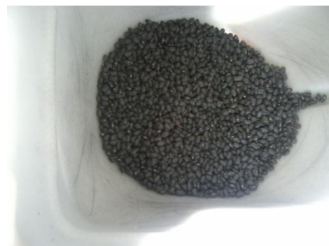
Figura 4. Interior do depósito de sementes sem o defletor cônico.
