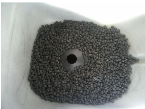
Figura 3. Interior do depósito de sementes com o defletor cônico
