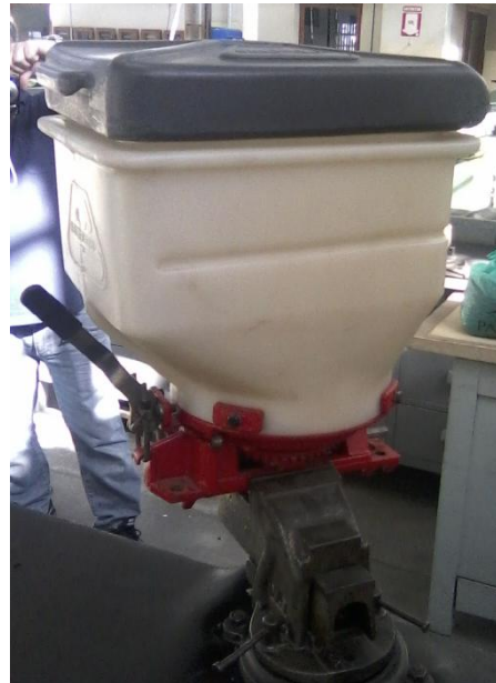
Figura 2. Depósito de sementes e disco dosador de sementes acoplado à morça.
