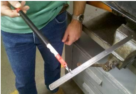
Figura 1. Medição indireta do torque empregando-se o dinamômetro.
