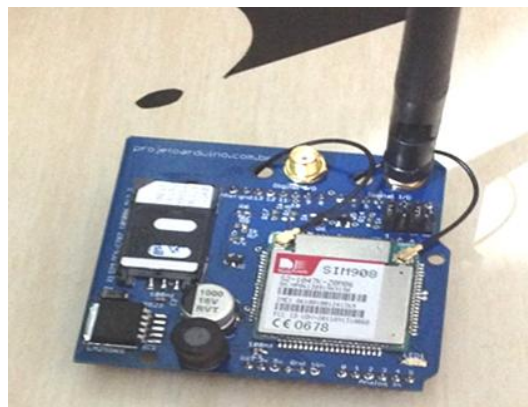
Figura 1: Plataforma Arduino e dispositivo GPS/GSM.
