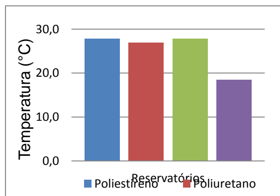
Figura 2: Temperatura média da água no interior de reservatórios revestidos com poliestireno, poliuretano e polietileno e a temperatura média do ar.
