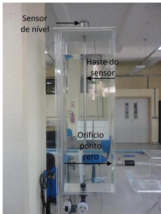
Figura 3 - Sistema completo e indicação do orifício
