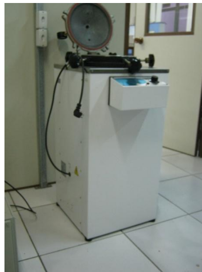
Figura 2: Autoclave vertical marca Phoenix, modelo AV-18, utilizado no processo de obtenção de fibras de talos de casca de banana.
