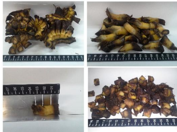
Figura 1: (a) Talos de banana limpos; (b) Talos separados; (c) Gabarito para corte; (d) Talos cortados com 1 cm de comprimento.
