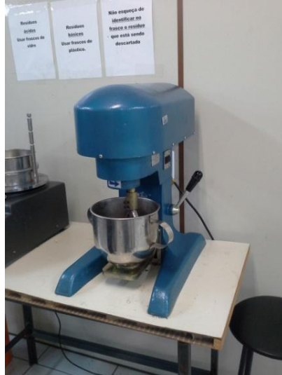
Figura 4: Argamassadeira da marca Contenco, modelo I-3010, utilizado no processo de obtenção de fibras de talos de casca de banana.
