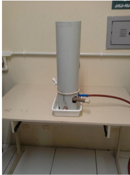
Figura 6: Lavadora de torre usada no processo de obtenção das fibras de talos de casca de banana.
