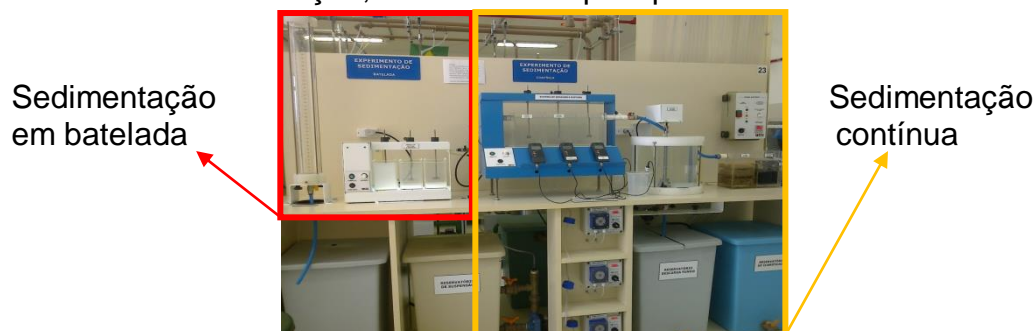
Figura 1 – Estação de tratamento de águas em escala laboratorial.
