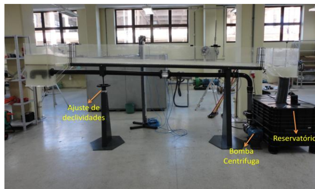
Figura 1: Sistema de circuito fechado, canal didático de acrílico para estudos de escoamento em superfície livre.
