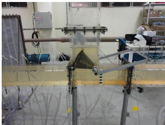
Figura 1 – Modelo de comporta utilizado no trabalho.
