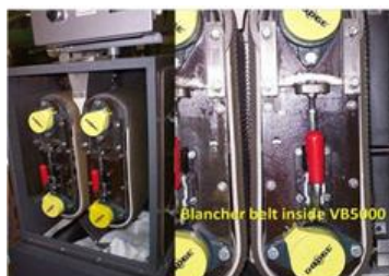
Figura 2 - Equipamento utilizado para a retirada da pele e do embrião do amendoim
