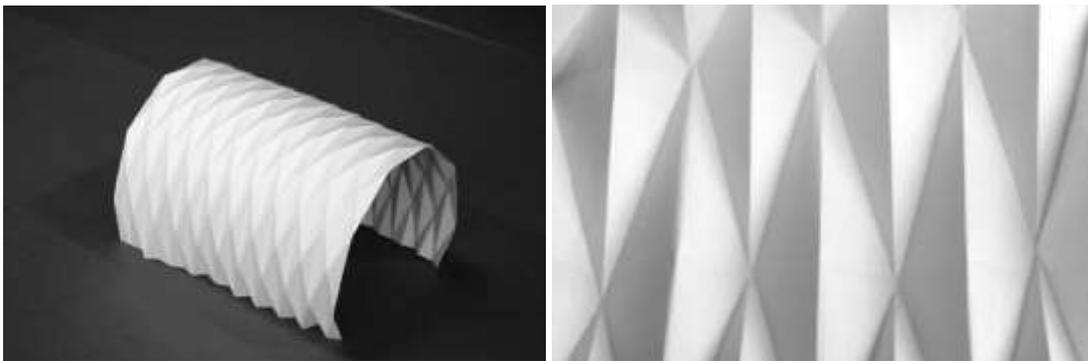
**2.3. Padrão Diagonal:** Diferenciado do padrão yoshimura por ter uma base paralelogramo que é dobrada em sua diagonal, apesar de ter uma posição paralela, as bordas são viradas para cima diagonalmente e formará uma serie das dobras paralelogramos distorcidas ou helicoidais.
