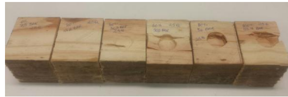
Figura 4 – (a) Gráfico do comportamento do SHCF (b) Corpos de prova de madeira com diferentes intensidades da força aplicada pelo Atuador Hidráulico.
