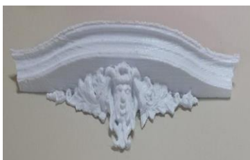
Figura 3: Gárgula impressa em 3D da parte inferior das janelas e fachada de onde foi gerada a fotogrametria. Fonte Arquivo pessoal do autor.
