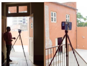
Figura 01: Processo de escaneamento e equipamento utilizado para obtenção da nuvem de pontos. Fonte: Autores
