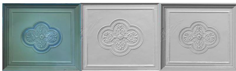
Figura 04: Estuque do quarto do menino convertido em malha, imagem comparativa entre os softwares Autodesk Recap, Meshlab e 3DReshaper , respectivamente. Fonte: Autores
