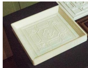
Figura 06: Estuque do quarto da menina impresso a partir da malha gerada pelo 3DReshaper . Fonte: Autores
