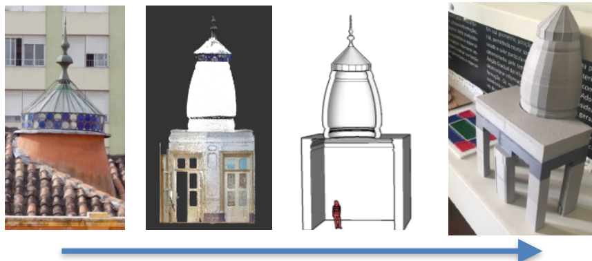
Figura 2 - Geração de objetos táteis pelo grupo Modela. Na sequência, da esquerda para direita: foto do local; nuvem de pontos; modelagem 3D; objeto tátil impresso 3D. Fonte: Arquivo GEGRADI.
