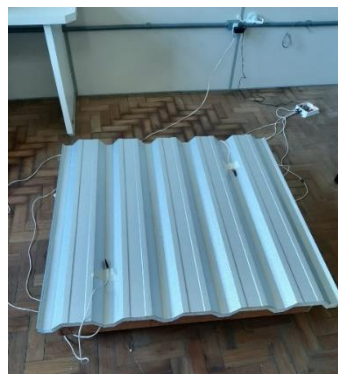
Figura 3 – Ensaio em laboratório e localização dos sensores.
