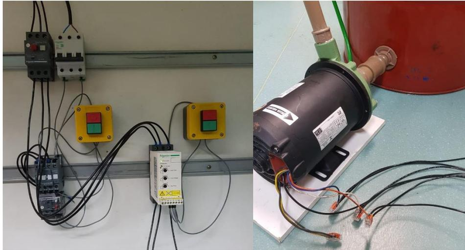
Figura 1. Esquemático elétrico e acoplagem motobomba e reservatório.
