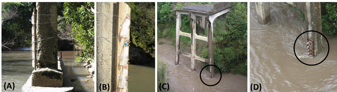
Figura 2. Tábua de madeira com os amostradores fixada à direita da seção transversal do curso d'água, em um pilar da ponte Cordeiro de Farias (A) e detalhe dos amostradores fixados verticalmente um acima do outro na tábua de madeira (B).
