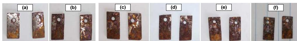
Figura 3: Amostras de aço expostas à atmosfera industrial após 30 (a), 60 (b), 90 (c), 120 (d), 150 (e) e 180 (f) dias.
