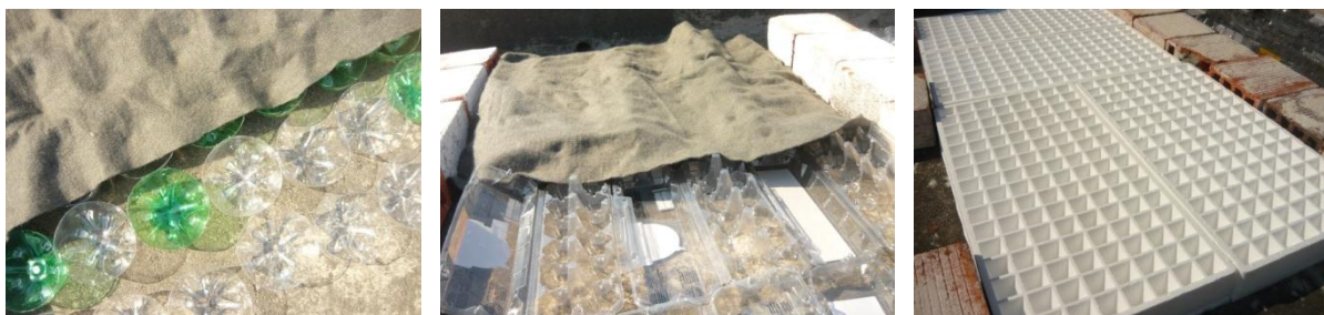
(a) Fundo de garrafa pet 2 l (b) caixas de ovos de plástico (c) Placas sementeiras Figura 2: dispositivos para armazenamento de água em estudo. Fonte: autores
