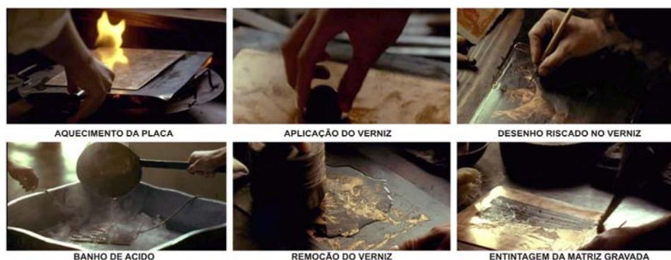
Com o procedimento que aqui está sendo apresentado, no lugar do verniz líquido à base de hidrocarbonetos, utilizamos uma película de vinil auto-adesivo. E, no lugar do ácido nítrico, usamos a gravação por eletrólise. Para a gravação, a área
