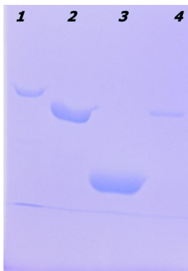
Figura 1: Teste de expressão das proteínas secretadas de C. pseudotuberculosis em eletroforese em gel de SDS-PAGE 12%. (1): rCP40 40 KDa, (2): Proteína recombinante rCP_SPLA 38KDa purificada, (3): Proteína recombinante rCP_SEC 24 KDa purificada, (4): Proteína recombinante rCP_SPLA 38KDa purificada.
