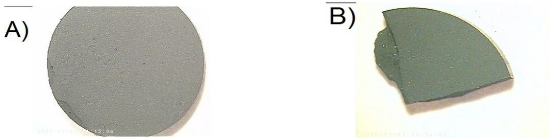
Figura 1: NA figura A) temos a amostra  $\text{YBa}_2\text{Cu}_3\text{O}_{7-\delta}$  pura (massa de 0,493 g) e a figura B) mostra um fragmento da amostra de  $\text{YBa}_2\text{Cu}_3\text{O}_{7-\delta}$  com 17% da fase Y211. (massa original de 0,483 g).
