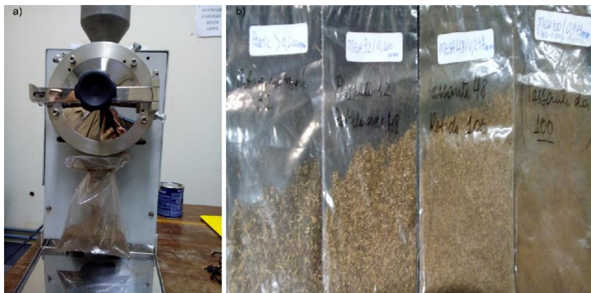
Figura 05 - Moinho de facas (a) e fibras após peneiramento em peneiras de Mesh 32, 48 e 100 respectivamente (b)
