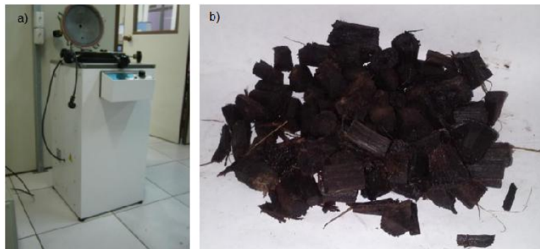
Figura 03 - Autoclave da marca Phoenix (a) e talos de banana após a autoclavagem
