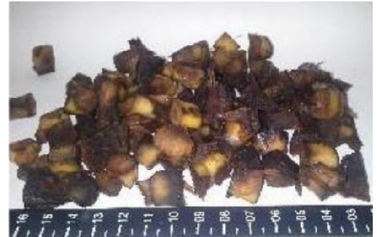
Figura 02 - Talos fatiados utilizados na obtenção das fibras
