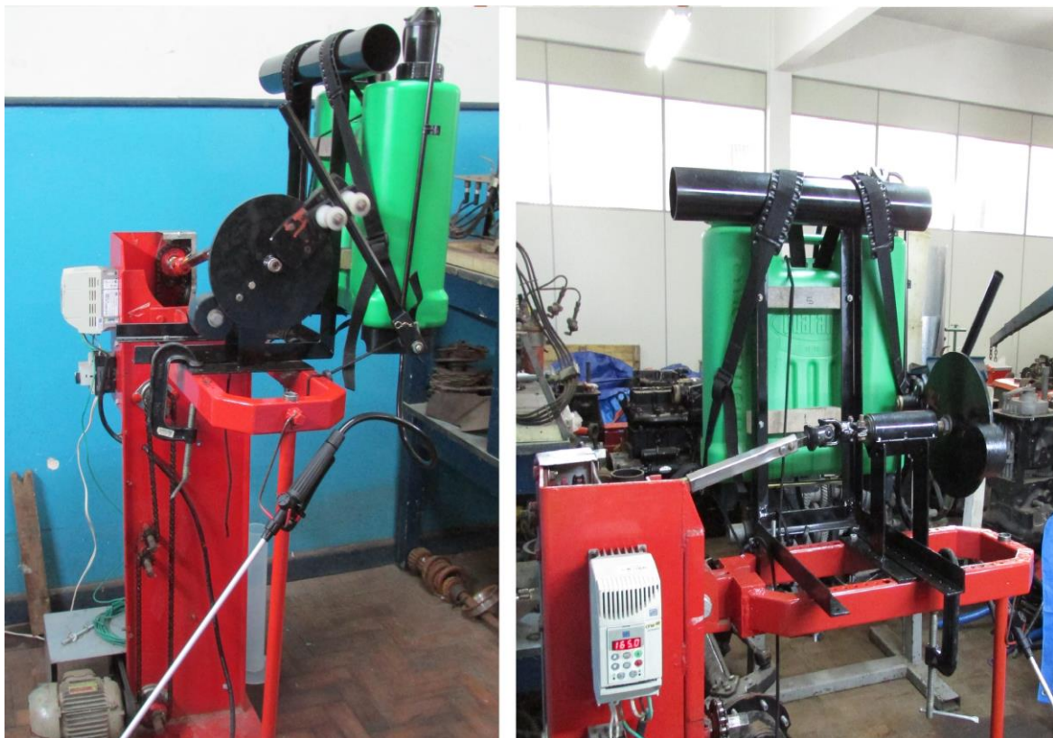
Figura 1. Sistema biela manivela do tipo Scotch Yoke Mechanism
