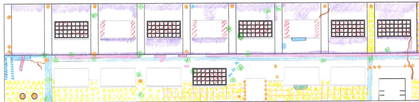
Figura 05: Mapeamento das manifestações patológicas na fachada oeste
